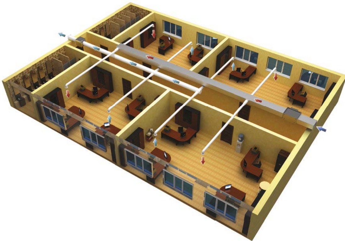
Wariant zastosowania centrali wentylacyjnej MPA w celu organizacji wymiany powietrza
