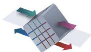
Przykład pracy płytowego wymiennika krzyżowego
