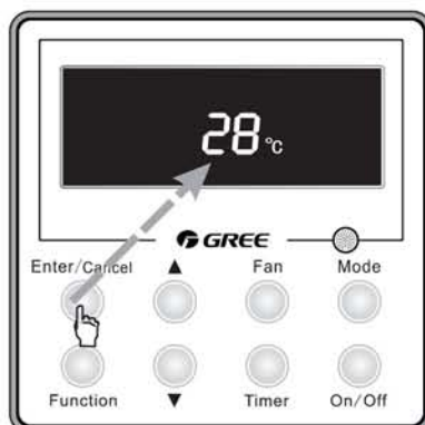
Naciśnij przycisk Enter / Anuluj , aby zapisać zmiany i wyjść z menu ustawień. Funkcja jest aktywowana.
