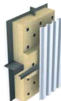
13 Ścianka filtra spalin
