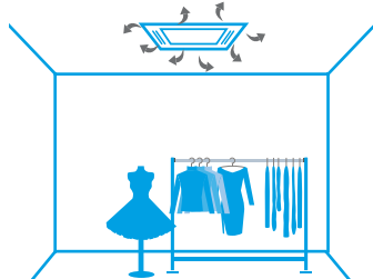
Rozkład powietrza z zabrudzonym filtrem
