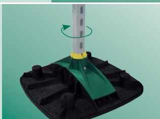
Adapter pozwalający na obracanie szyny Strut 41 x 41 w podporze o 360°
