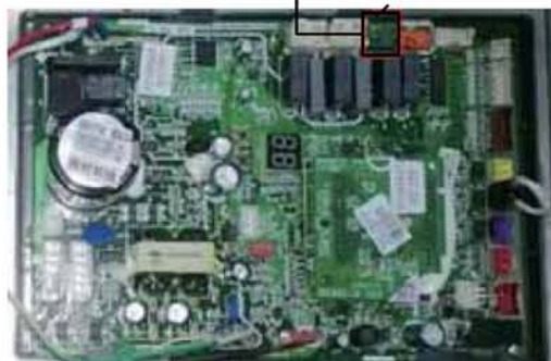
Kabel grzejny elektryczny jest podłączony do portu VA-1
