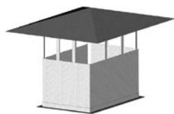
WYRZUTNIA DACHOWA TYP B WG BN-70/8865-31
