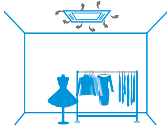
Rozkład powietrza z zabrudzonym filtrem
