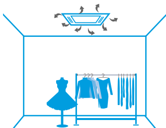
Rozkład powietrza z zabrudzonym filtrem
