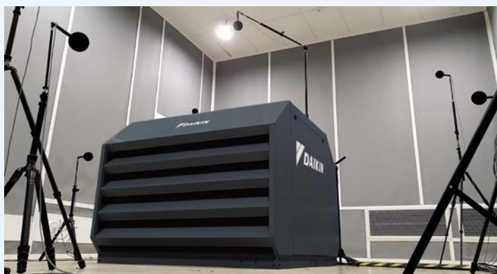
Pomiar poziomu mocy akustycznej w komorze akustycznej
