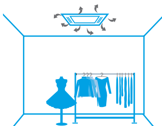
Rozkład powietrza z zabrudzonym filtrem
