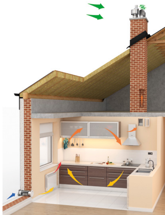
System wentylacji hybrydowej w domu jednorodzinnym
