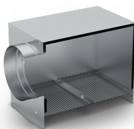
Rysunek 6. Skrzynka bez przepustnicy, z deflektorem.
