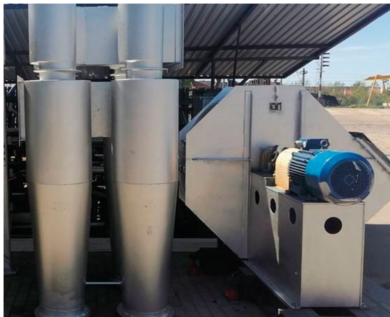
Na zdjęciu przykład zastosowania baterii cyklonów wraz z wentylatorem promieniowym WVOax.
