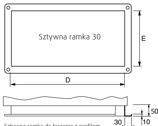
Sztywna ramka do łączenia z profilem EP/LSM 30 mm z otworami w narożnikach.
